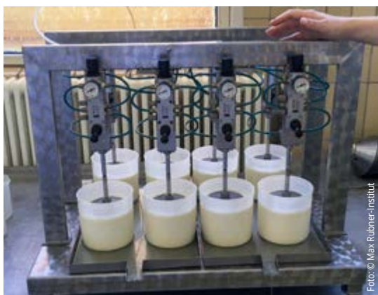
Abbildung 7: Käseherstellung im Labormaßstab
